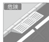
乗入れブロック
